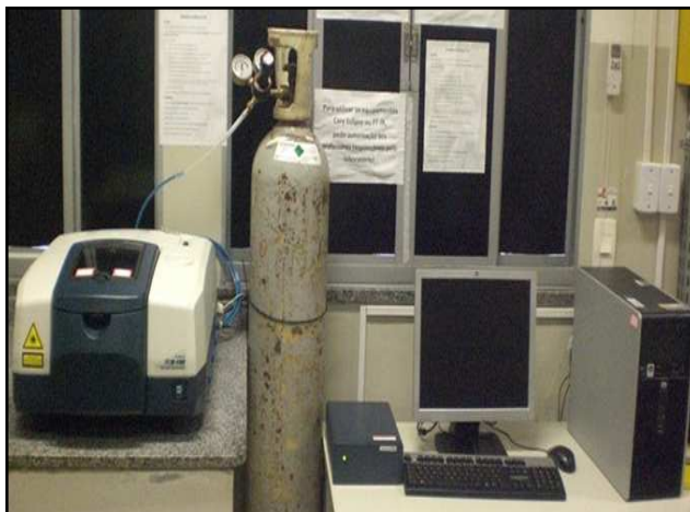
Figura 17 - Espectrofotômetro de infravermelho JASCO modelo 4000 na região de 500 – 4000 \text{cm}^{-1} .
