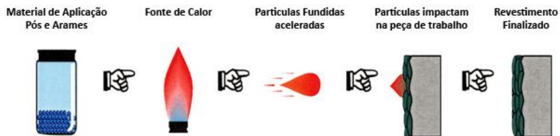
Figura 1 : Esquema de aspersão térmica. Fonte: http://www.comersul.com.br/secao.php?nome=aspersao-termica acessado 18/05/2014
