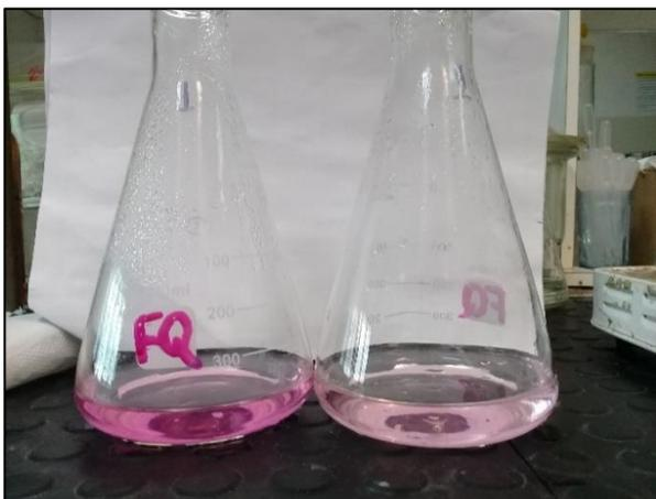
Após os 3 minutos de fervura, retirou-se da chapa de aquecimento e esperou esfriar. Em seguida, adicionou as gotas de fenolftaleína. A cor da amostra, após adicionar o indicador, ficou rósea, alegando que a acidez carbônica é igual a total.
