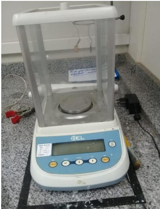
3 – Depois que os béqueres estiverem em temperatura ambiente, os mesmos foram direcionados para a balança, a fim de se obter o peso 1, isto é, o peso da vidraria sem a amostra.
