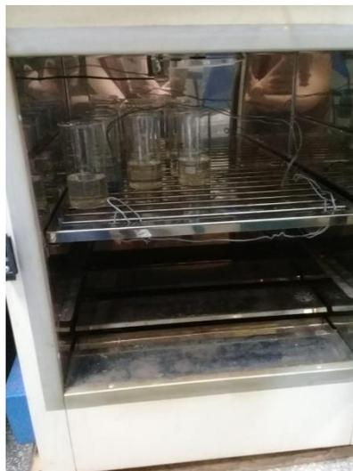
4 – Logo após a pesagem, colocou-se 100 ml da amostra, direcionando-as para a estufa. Após a evaporação de toda a água contida nos béqueres, os mesmos foram encaminhados, novamente, para o dessecador e, posteriormente, pesados, obtendo-se, assim, o peso 2.
