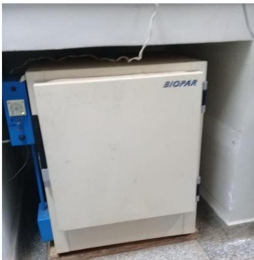
1 - Secagem dos béqueres com o intuito de retirar a umidade e, posteriormente, a pesagem dos mesmos, a fim de adquirir o Peso 1.
