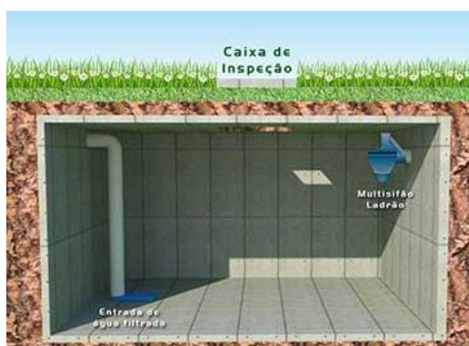
Figura 4 – Esquema de cisterna de alvenaria Fonte: EcoCasa, 2018
