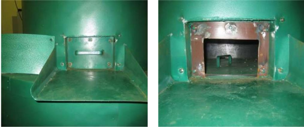
FIGURA 15. Porta para descarregar produto do leito de secagem em camada espessa.
