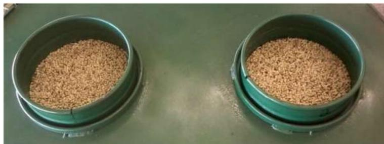
FIGURA 2. Camada delgada de grãos de cartamo disposta nas bandejas do secador.
