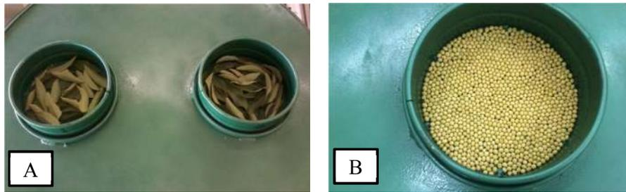
FIGURA 32. Secagem em camada delgada de folhas de guavira (A) e de sementes de soja (B).
