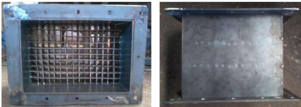
FIGURA 18. Homogeneizador de ar após o conjunto de resistências elétricas.
