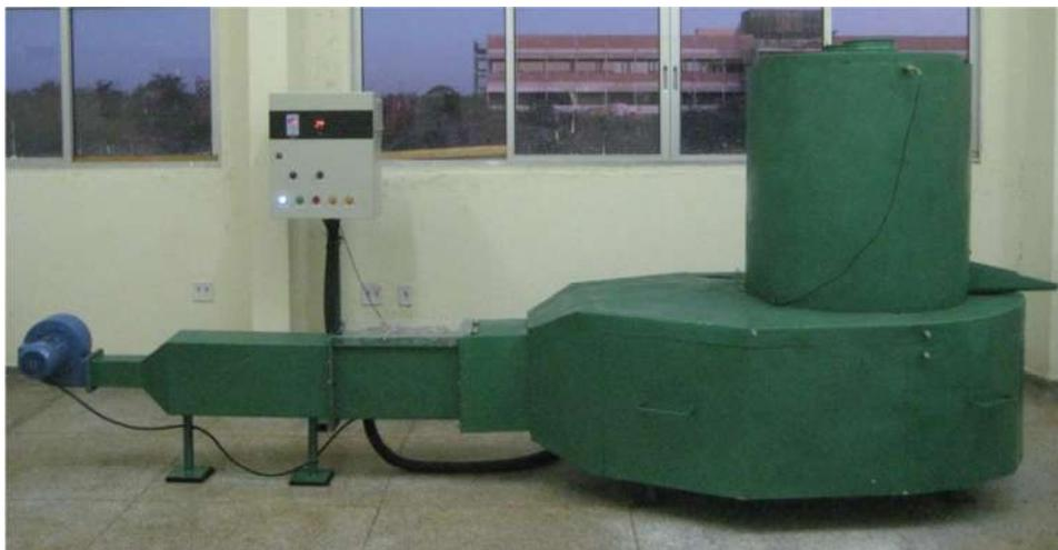
FIGURA 30. Secador experimental para secagem em camada delgada e espessa de produtos agrícolas.
