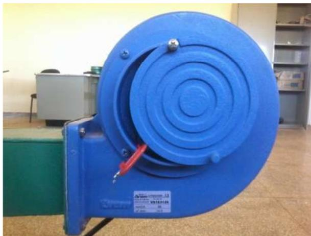
FIGURA 31. Diafragma para regular a entrada de ar no ventilador.
