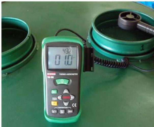
FIGURA 3. Verificação da velocidade do ar nas bandejas de secagem em camada delgada.
