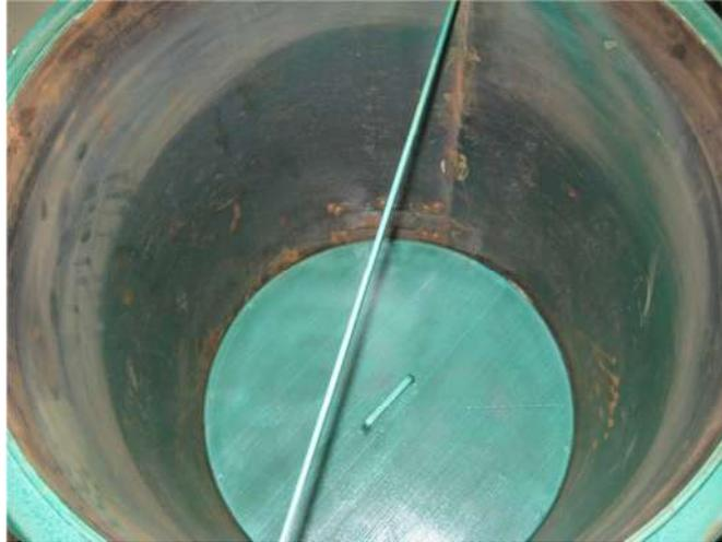
FIGURA 13. Interior do leito de secagem em camada espessa.
