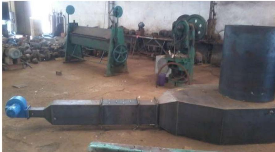
FIGURA 19. Estrutura do secador experimental concluída, ausente apenas o isolamento térmico.
