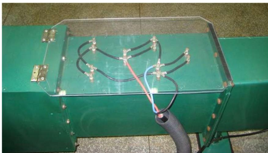
FIGURA 8. Conjunto de resistências elétricas instaladas no secador experimental.
