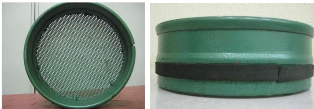
FIGURA 9. Bandeja do leito de secagem em camada delgada.
