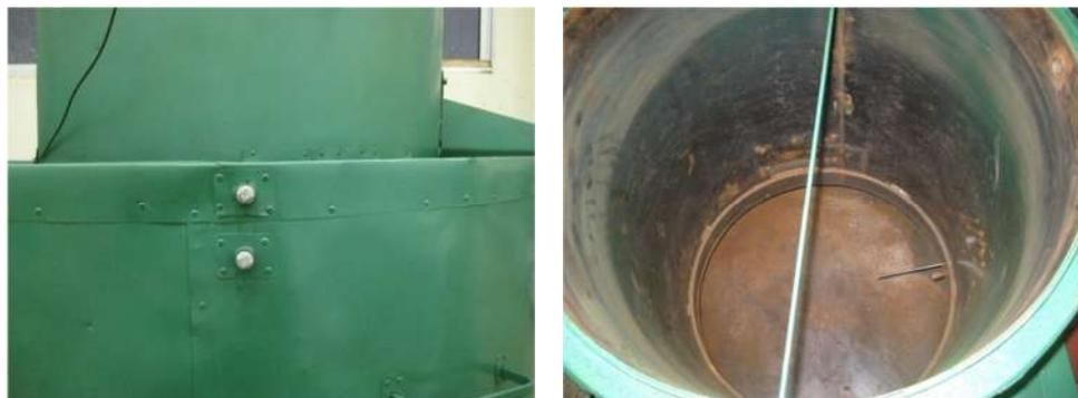
FIGURA 29. Posição do sensor de temperatura para secagem em camada espessa no secador experimental.
