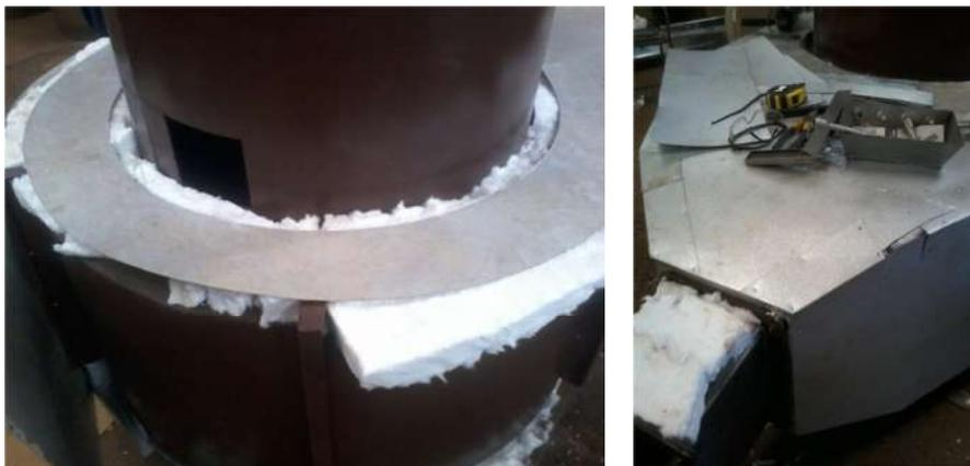
FIGURA 20. Revestimento com isolante térmico na estrutura do secador experimental.
