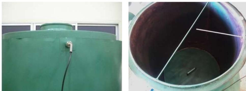
FIGURA 28. Posição do sensor de temperatura para secagem em camada delgada no secador experimental.
