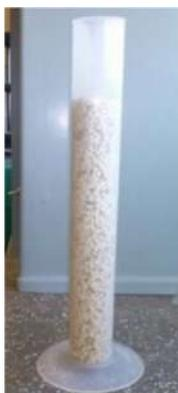
FIGURA 2. Ilustração da determinação da contração da massa dos grãos de cártamo durante a secagem, utilizando uma proveta de  $500 \text{ mL}$ .
