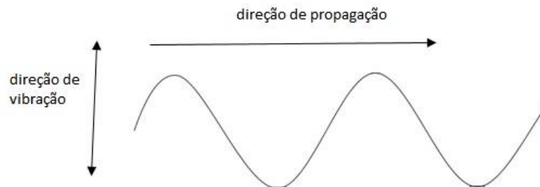
Figura 1.1 – Ilustração de uma onda transversal, de sua direção de vibração e propagação.
