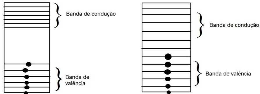
Figura 1.6 – Representação esquemática das bandas de valência e bandas de condução em isolantes e condutores
