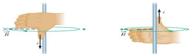
Figura B: Esquema da regra da mão direita. O polegar indica o sentido da corrente elétrica, e os demais dedos indicam o sentido do campo magnético. Fonte: https://donaatraente.wordpress.com/enquadramento-teorico/campo-magnetico/regras-para-determinar-o-sentido-do-campo-magnetico .
