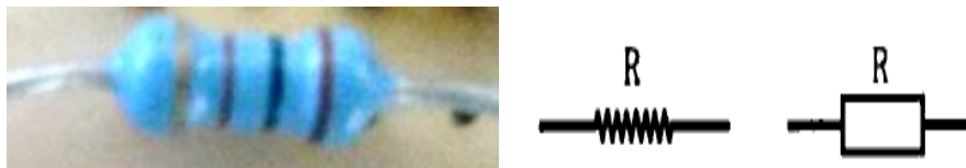
Figura 1: Ilustração de um resistor elétrico comercial e suas simbologia. Fonte: Autoria própria
