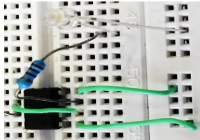
Figura 16: Conexão do resistor R_3 e LED junto ao CI 555. Fonte: Autoria própria
