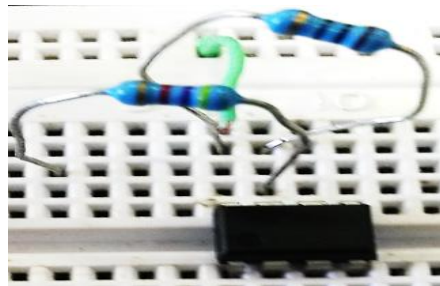
Figura 13: Posicionamento do resistor R_1 e ligação do VCC. Fonte: Autoria própria
