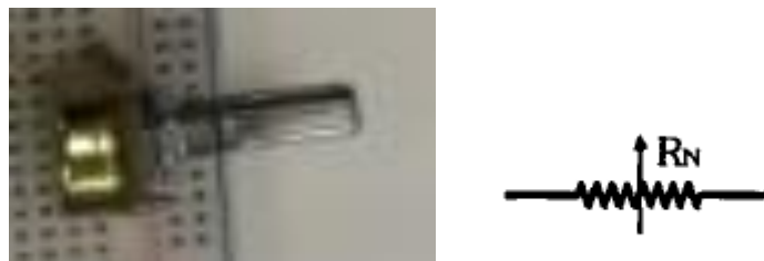
Figura 4: Ilustração de um potenciômetro e sua simbologia. Fonte: Autoria própria
