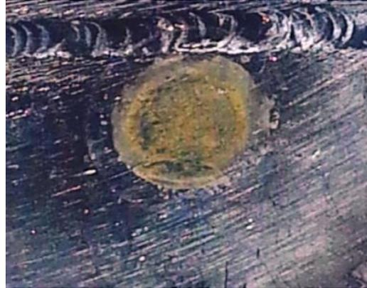
Após as medidas de EIS para a região afetada pelo calor, constatou-se adesão de produtos de corrosão na superfície da amostra, conforme apresentado na Figura 20.
