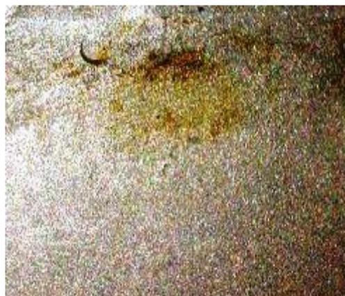
Observou que após sete dias em contato com a solução de NaCl 3,5% a amostra de aço inoxidável para a zona termicamente afetada pelo calor, apresentou produto de corrosão aderido a superfície, como mostra a Figura 16.
