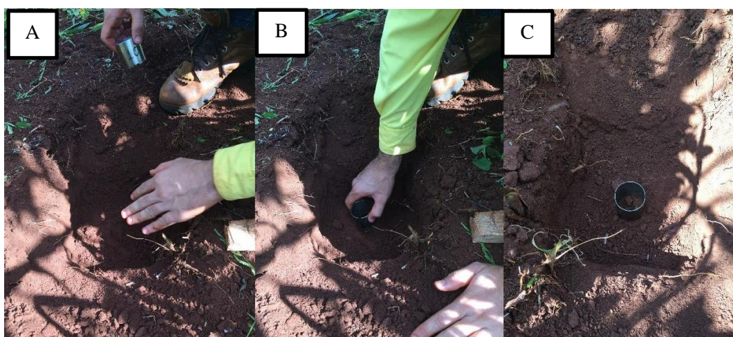
(A) Trincheira (0,30 m x 0,30 m) aberta para introdução do anel; (B) Introdução do anel no centro da trincheira; (C) Anel introduzido no centro da trincheira pronto para ser removido com a amostra de solo com estrutura preservada.
