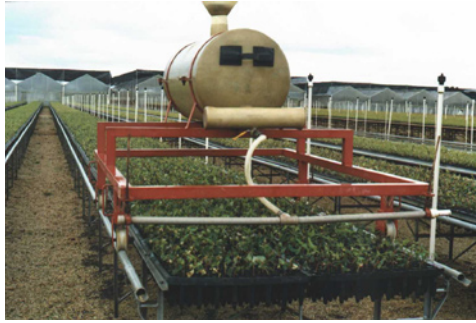
Figura 18 – Sistema de fertilização de mudas produzidas em tubetes, sobre trilhos (exemplo em viveiro de eucalipto).
