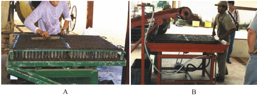
Figura 19 – Nivelamento de substrato (A) e mesa vibratória para compactação (B)
