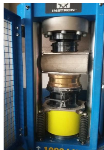
Figura 5. Ensaio à tração por compressão diametral.
