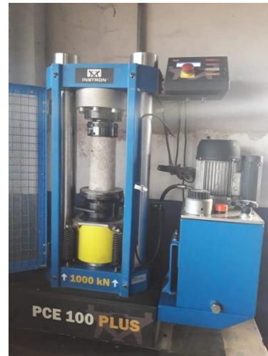
Figura 4. Ensaio de compressão.
