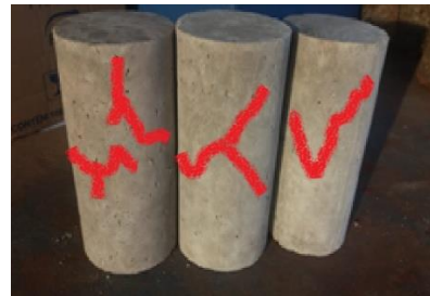
Figura 9: Forma de ruptura dos Corpos de prova.
