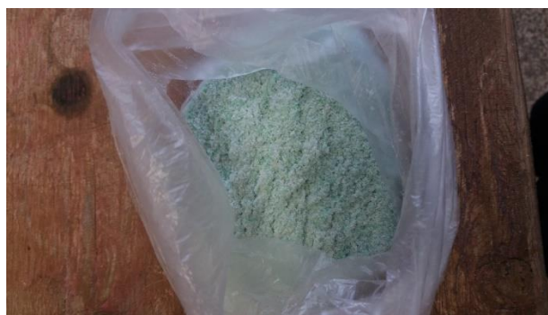
Figura 2. Granulometria obtida através do processo de granulação no moinho de facas.
