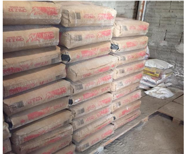
Figura 8. Estocagem adequada das pilhas de cimento da empresa A.
