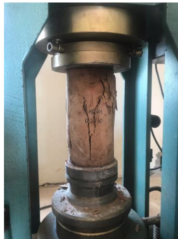
Figura 2. Ruptura do corpo de prova.
