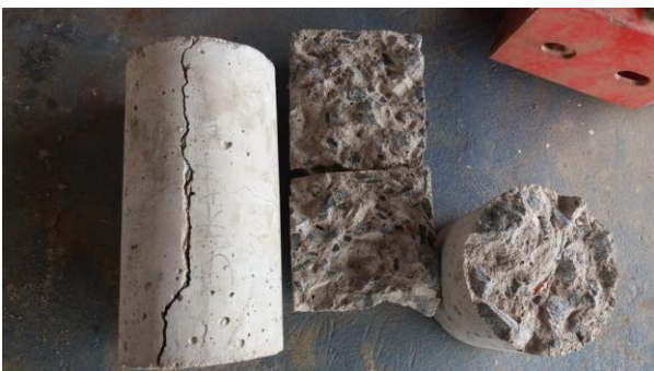
Figura 2. Peça rompida no ensaio de resistência à tração por compressão diametral (28 dias).
