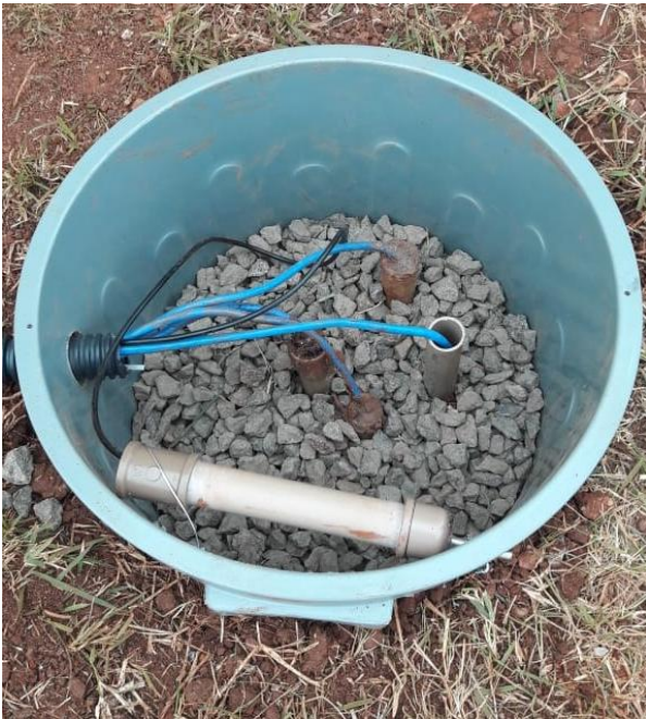
Figura 8. Perfurações no solo onde são inseridos os sensores DS18B20.
