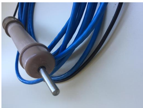
Figura 4. Sensor DS18B20 com suporte de PVC e cabo CAT6.
