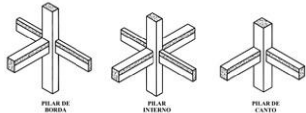
Figura 1. Classificação dos pilares referente a posição no pavimento.
