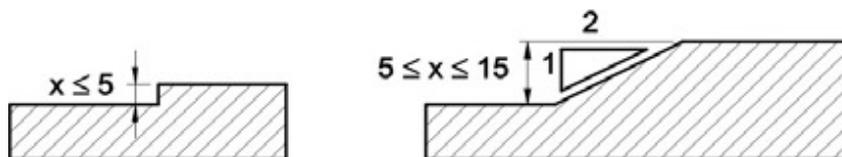
Figura 28 – Tratamento de desníveis, medidas em milímetros (ABNT, 2004 p. 39)
