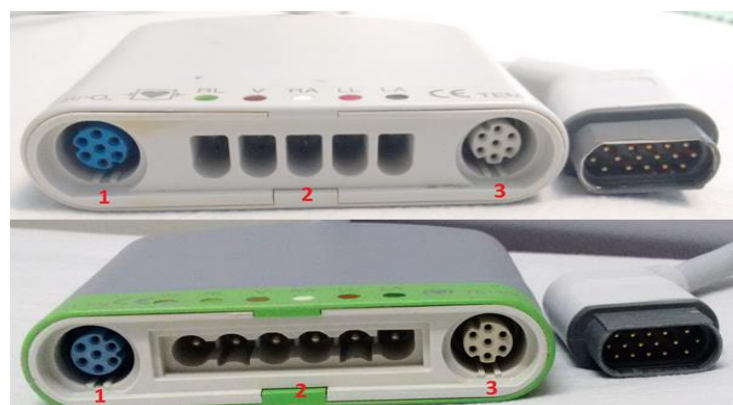
Figura 43: Comparação das diferenças de conexões entre cabos Multmed 5 e Plus .
