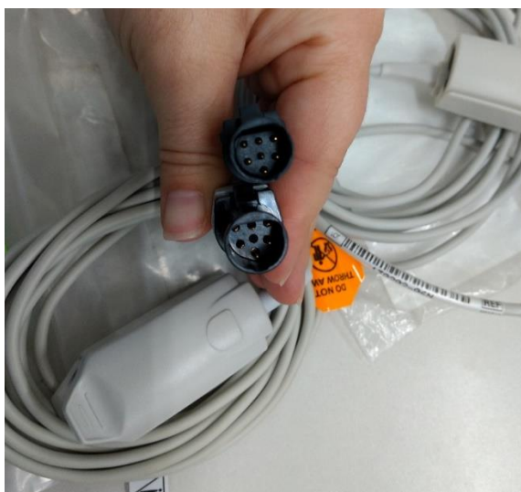
Figura 30: Sensores de oximetria tipo clip Dixtal com pino no meio e sem.
