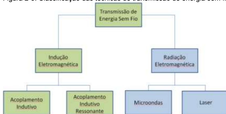
Figura 2-3: Classificação das técnicas de transmissão de energia sem fio.
