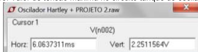
Figura 4-13: Valor de tensão máxima no circuito tanque do oscilador Hartley.
