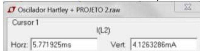
Figura 4-17: Valor de corrente máxima no circuito receptor do oscilador Hartley.
