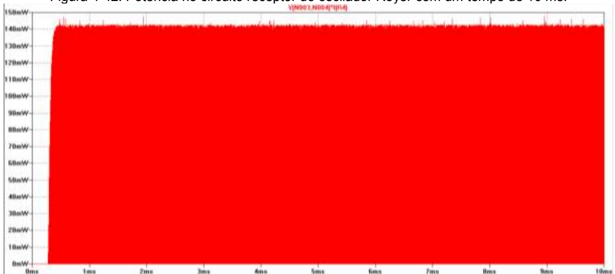
Figura 4-42: Potência no circuito receptor do oscilador Royer com um tempo de 10 ms.
