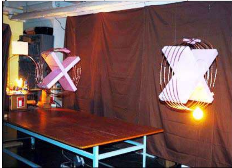
Figura 2-2: Protótipo do MIT para iluminar uma lâmpada de 60 W.
