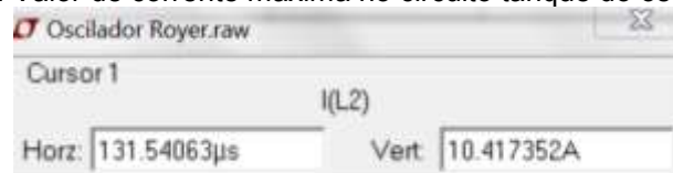
Figura 4-50: Valor de corrente máxima no circuito tanque do oscilador Royer.
