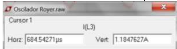
Figura 4-53: Valor de corrente máxima no circuito receptor do oscilador Royer.
