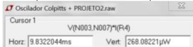
Figura 4-36: Valor de potência máxima no circuito receptor do oscilador Colpitts.
