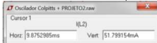
Figura 4-35: Valor de corrente máxima no circuito receptor do oscilador Colpitts.
