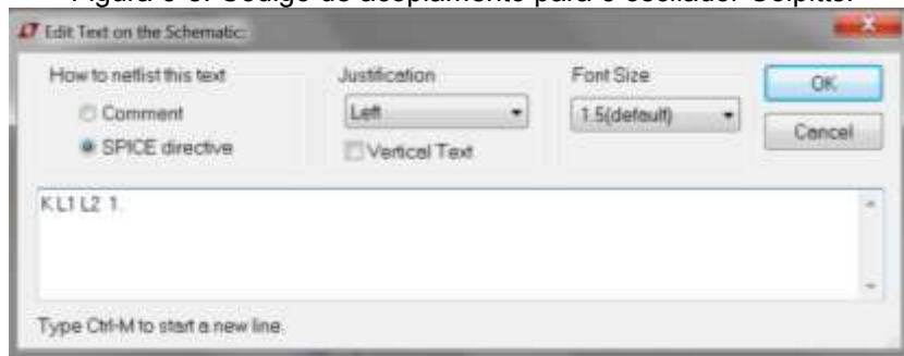
Figura 3-8: Código de acoplamento para o oscilador Colpitts.
