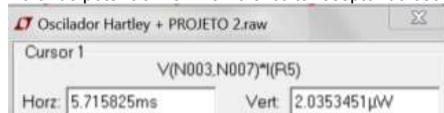
Figura 4-18: Valor de potência máxima no circuito receptor do oscilador Hartley.
