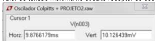
Figura 4-34: Valor de tensão máxima no circuito receptor do oscilador Colpitts.
