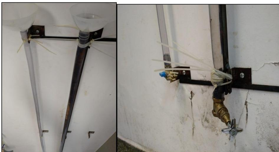
Figura 26: Protótipo do viscosímetro de Stokes.
