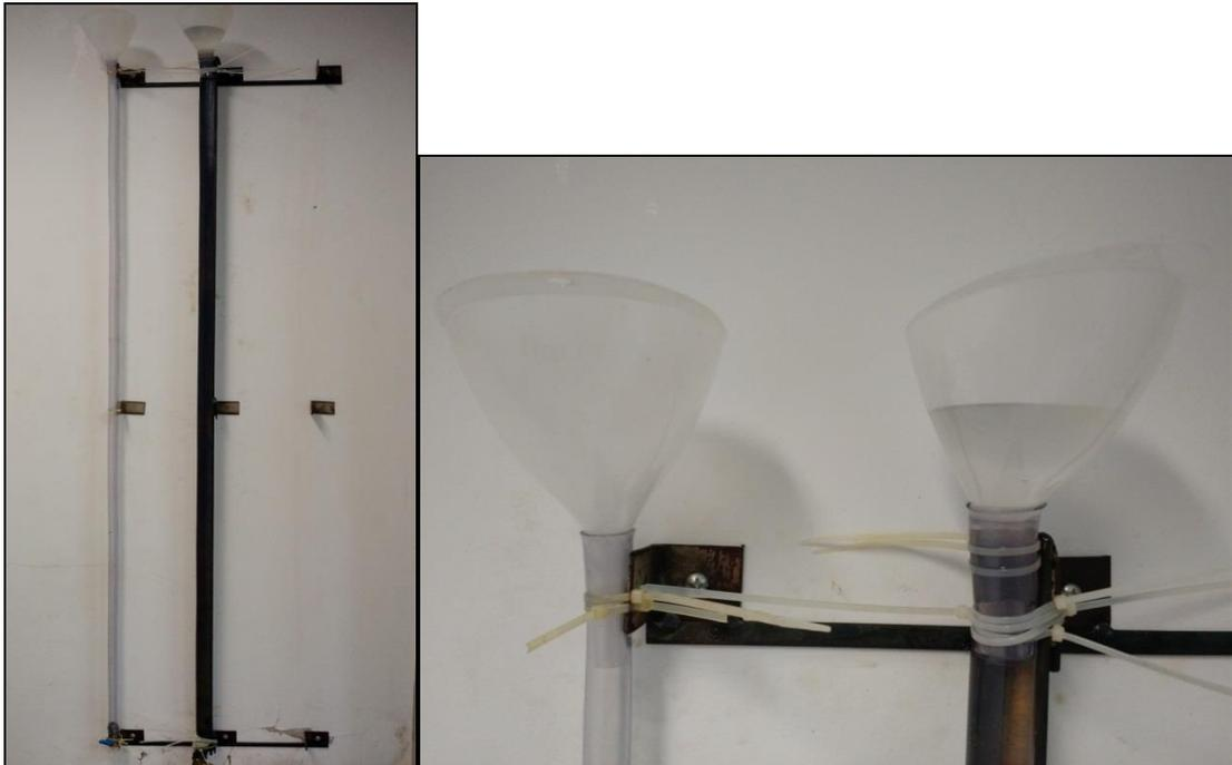
Figura 25: Protótipo do viscosímetro de Stokes.
