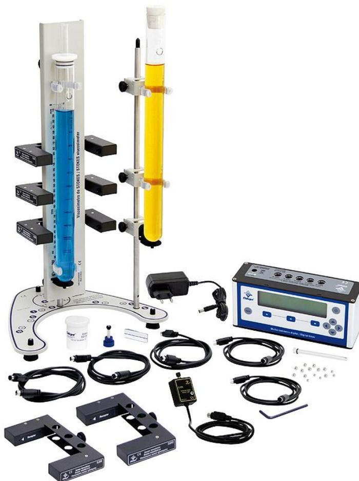
Figura 16 - Viscosímetro de Stokes. Fonte: (UNICAMP, 2018)
