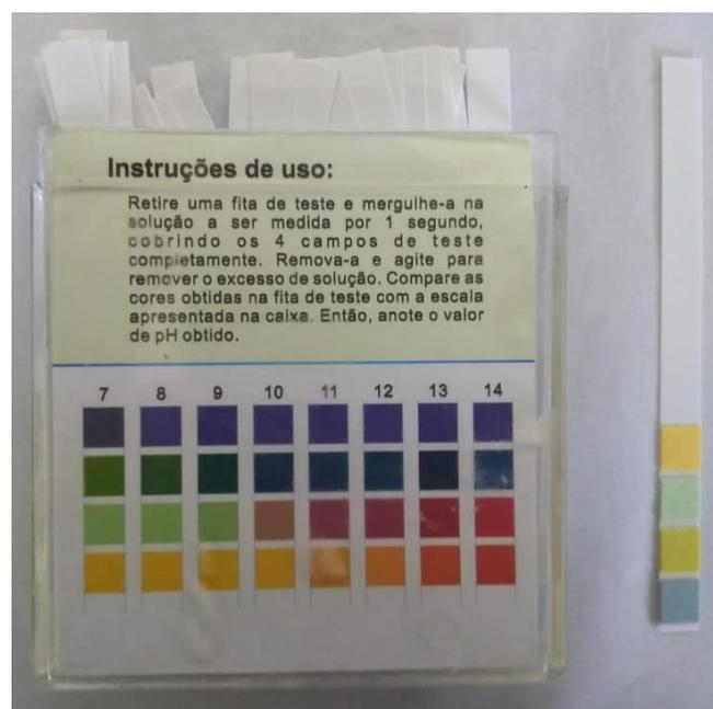
Figura 15 - Escala do pH das fitas analisadas (7-14).
