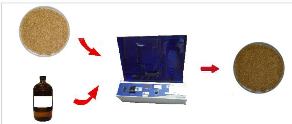
Figura 9 – Esquema da etapa de mercerização das fibras da vagem de amendoim in natura .
