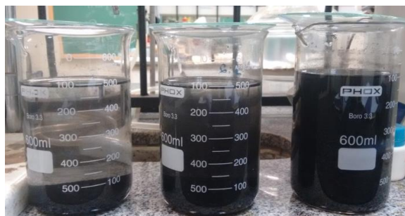
Figura 11 - Foto ilustrativa da lavagem do CA.
