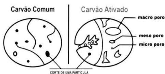
Figura 3 - Esquema simplificado da estrutura dos poros dos CAs.
