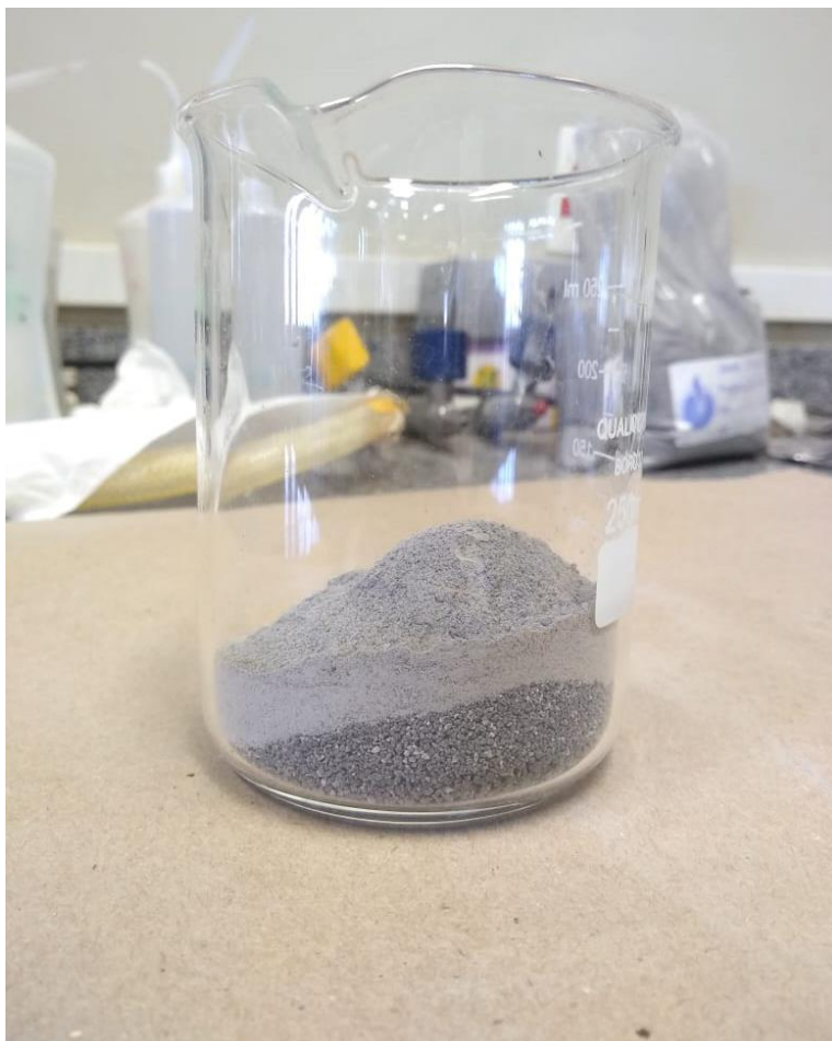
Figura 19. Foto da variação de partículas obtidas após o peneiramento do calcário.
