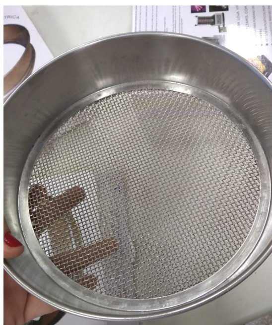
Figura 5. Foto de uma peneira utilizada para análise de granulometria.
