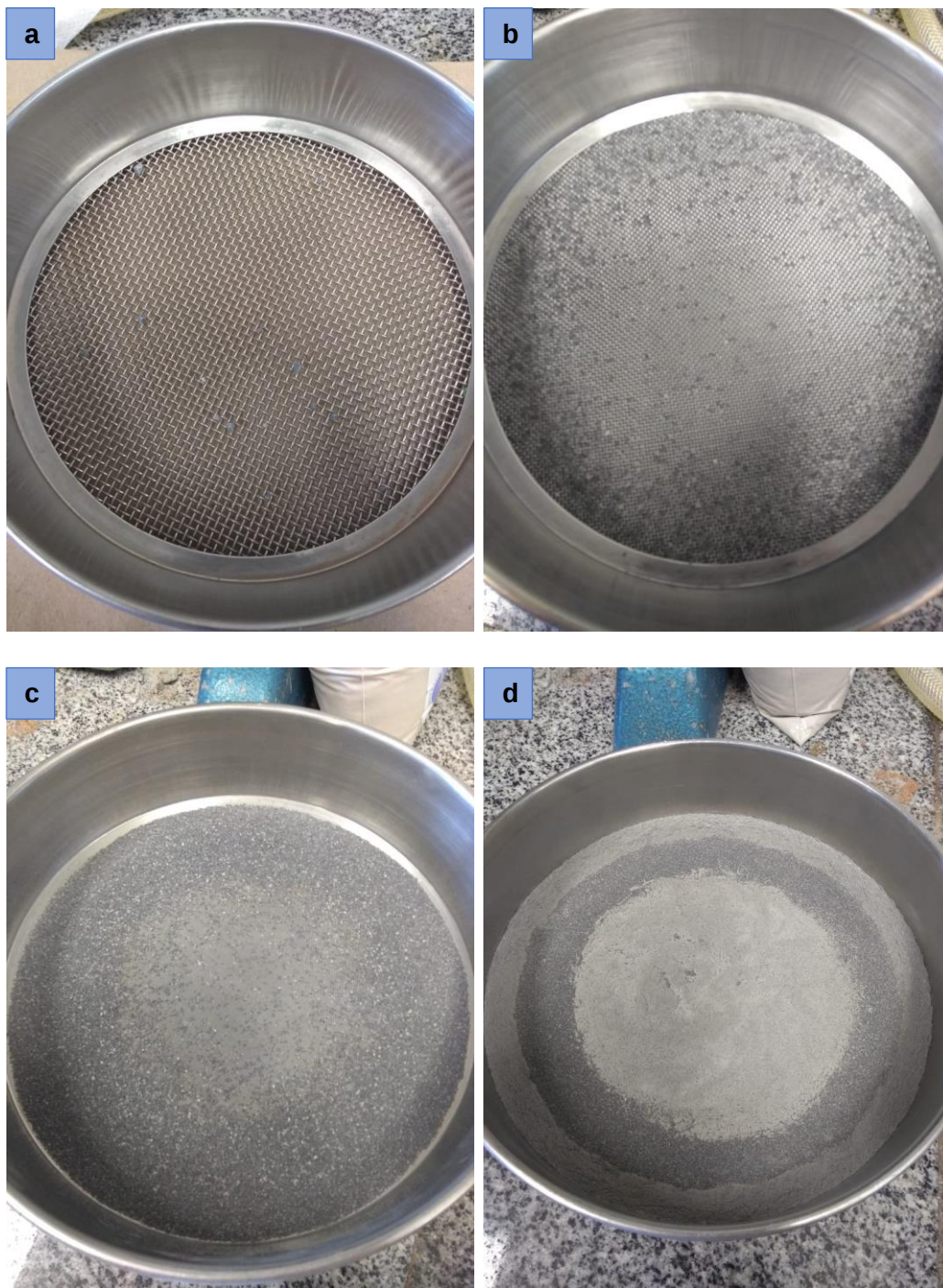
Figura 18. Foto do material retido nas peneiras ABNT 10 (a), 20 (b), 50 (c) e fundo (d).
