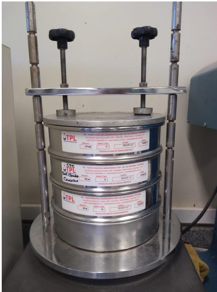
Figura 7. Foto das peneiras no agitador mecânico.
