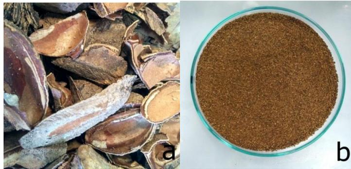
**Figura 12** – Amostras da casca da castanha-do-Brasil. a) Fibra *in natura*; b) Fibra triturada em moinho de facas com malha de 40 mesh
