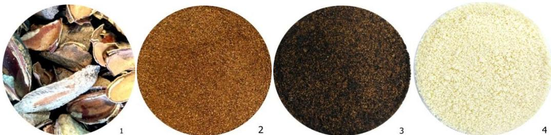
**Figura 15** – Etapas do processo de branqueamento. 1- Casca da castanha do Brasil; 2- Fibras trituradas *in natura*; 3- Fibras mercerizadas; 4- Fibras branqueadas.
