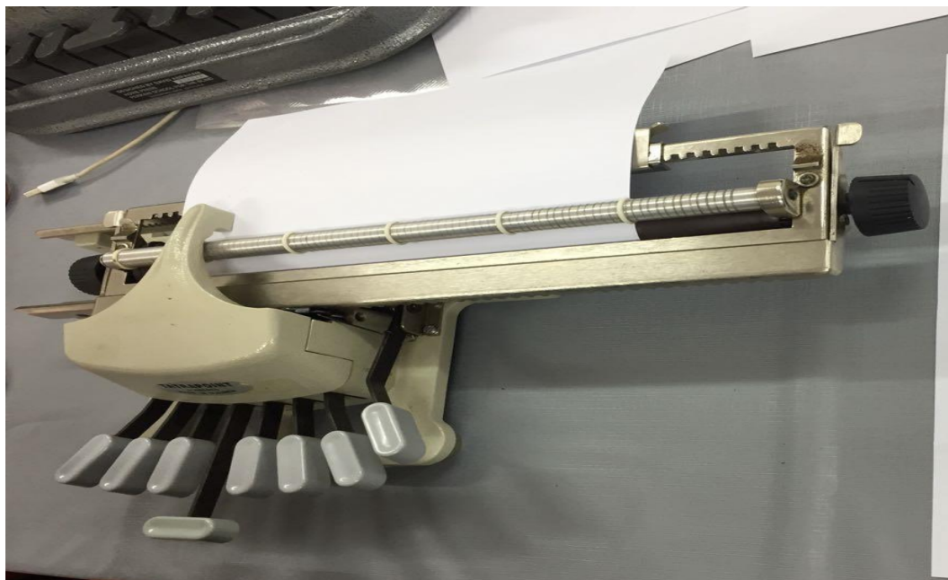
Máquina Tetrapoint utilizada para transcrever o braile
