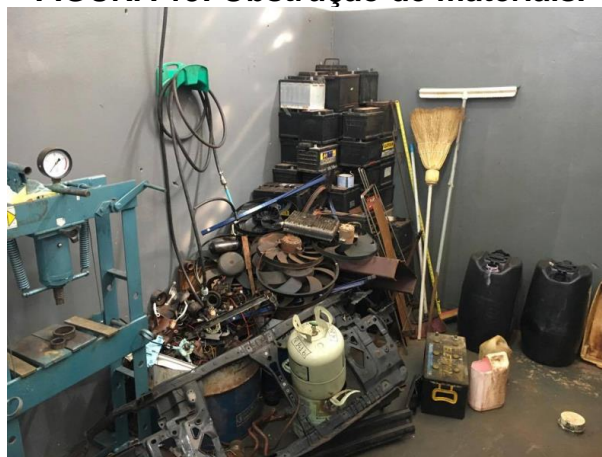
FIGURA 13: Obstrução de materiais.
