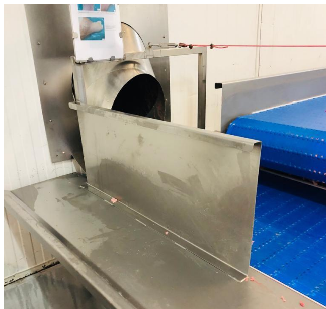
Figura 15: Barra de contenção fixada na curva. Fonte: elaborado pelo autor.
