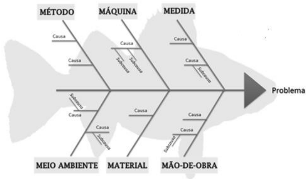
Figura 5: Estrutura de um diagrama de causa e efeito. Fonte: Bezerra, 2014.
