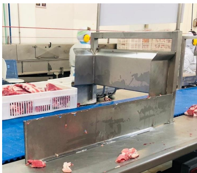
Figura 16: Barra de contenção fixada na emenda. Fonte: elaborado pelo autor.
