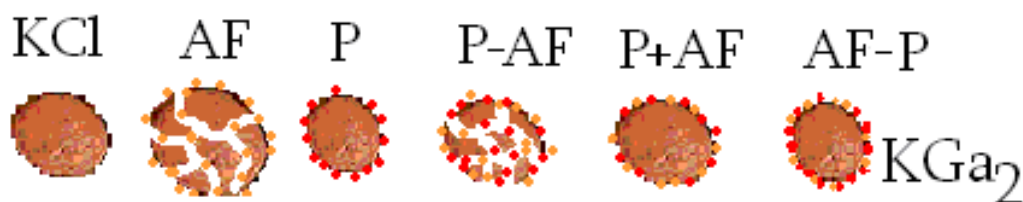
FIGURA 50. Proposta de modelo da estrutura das partículas de argila de \text{KGa}_2 após a incubação de fósforo (P) em altas concentrações e ácido fúlvico (AF). Para as ordens de incubação têm-se: primeiro P e posteriormente AF (P-AF), P juntamente com AF (P+AF) e AF primeiro e posteriormente P (AF-P)
