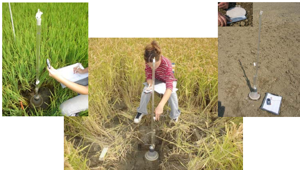
Figura 3. Determinação do ( K_{p_0} ) com “infiltrômetro de tensão” em diferentes momentos de desenvolvimento da cultura e em diferentes profundidades.
