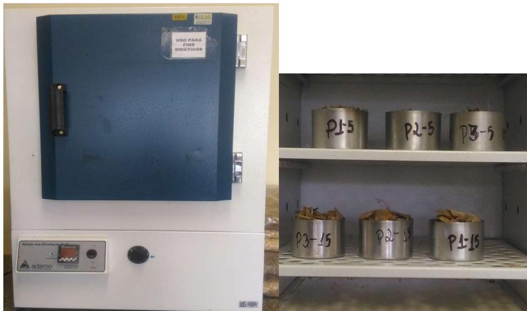
FIGURA 4. Estufa utilizada na secagem dos resíduos para determinação de umidade.
