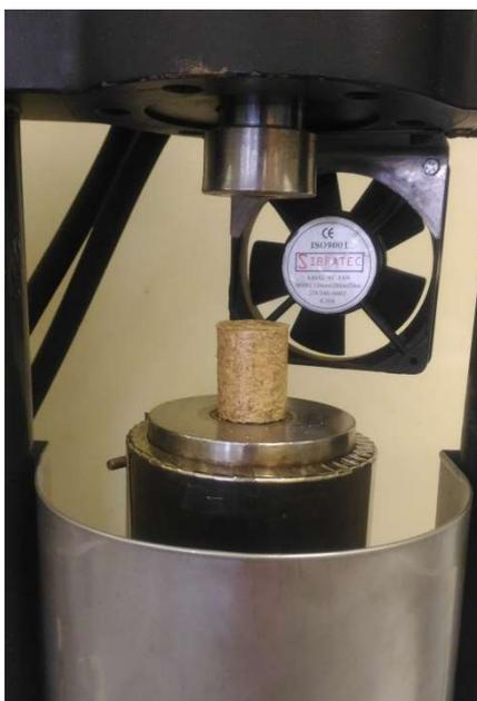
FIGURA 11. Briquete sendo retirado da matriz.
