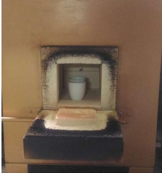
FIGURA 5. Recipientes de porcelana acondicionados na mufla para determinação de cinzas.
