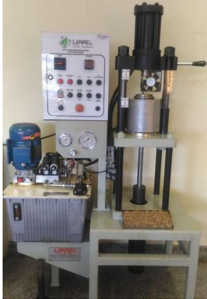
FIGURA 7. Briquetadora de laboratório LB-32
