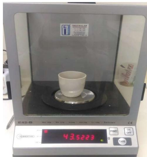
FIGURA 6. Determinação da massa dos recipientes de porcelana com cinzas em balança analítica, após serem retirados da mufla.
