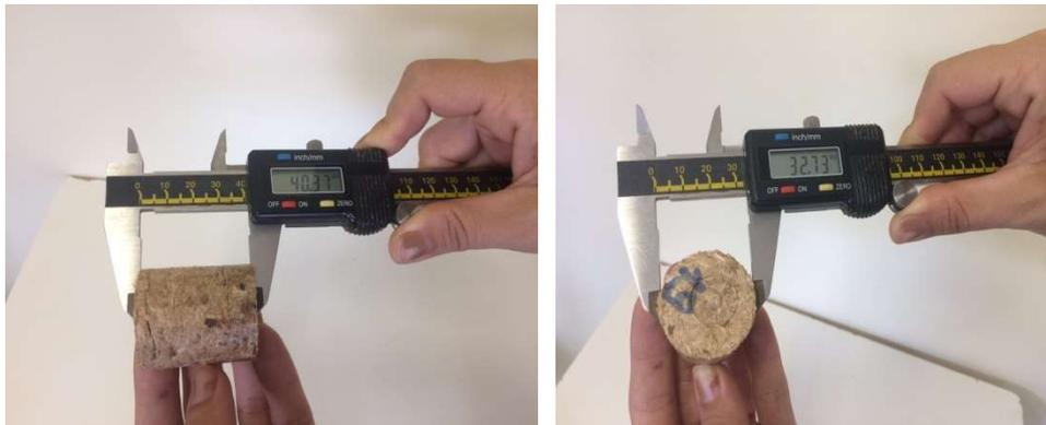
FIGURA 9. Determinação da altura e diâmetro dos briquetes
