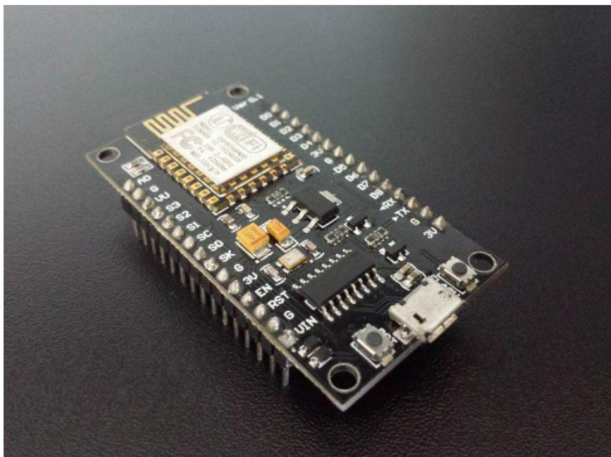
Figura 2: NodeMCU ESP8266. Fonte: (MORAIS, 2017)
