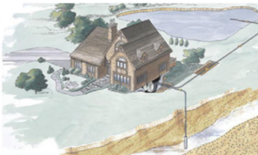
Figura 6 – Bomba de calor geotérmica vertical acoplada a uma bomba de calor com solo/água.
