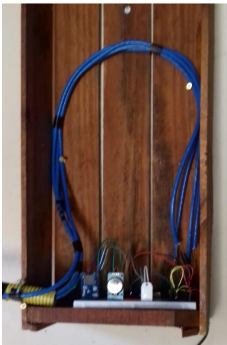
Figura 13 - Conexão final dos sensores ao Arduino.
