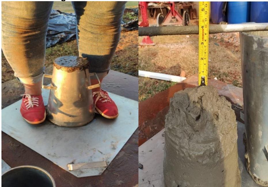
Figura 2: Ensaio de abatimento do concreto
