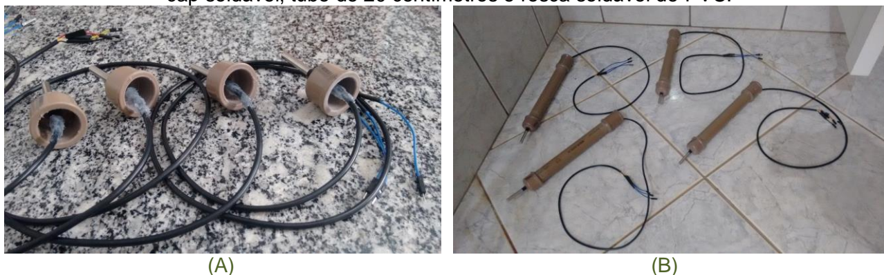
Figura 06 – Preparação das Ponteiras. (A) Sensor acoplado ao cap soldável de PVC, (B) União cap soldável, tubo de 20 centímetros e rosca soldável de PVC.
