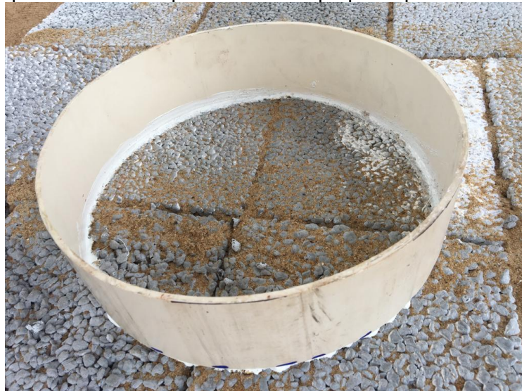
Figura 6: Preparo para o ensaio de permeabilidade proposto pelo Anexo A da NBR 16416.
