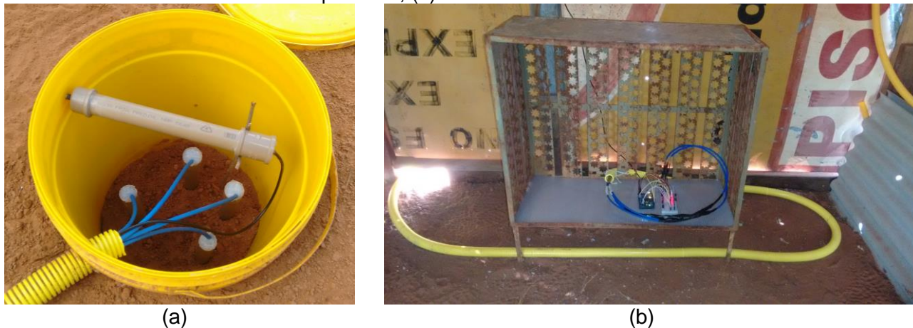
Figura 7 - Sistema de leitura, coleta e armazenamento de temperaturas do solo. (a) Sensores de temperatura, (b) Conexão ao Arduino.
