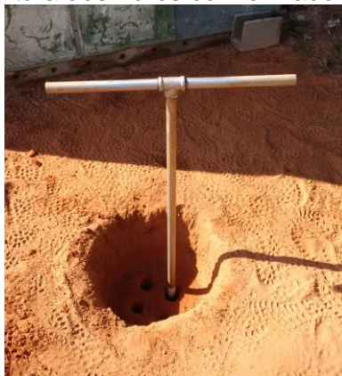
Figura 6 – Abertura dos Furos com o Trado Manual de 3/4".
