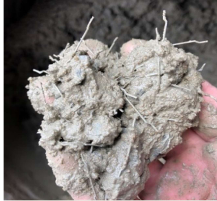
Figura 7 – Detalhe do concreto após a adição das fibras. Na foto, a taxa de fibras utilizada foi de 100Kg de fibras por m 3 de concreto.
