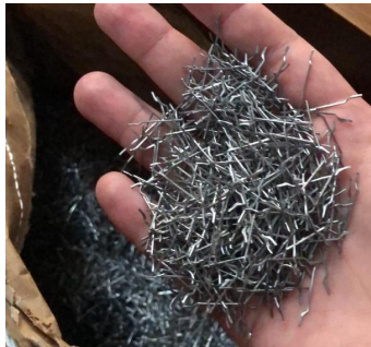
Figura 10 - Fibras de aço utilizadas no presente trabalho, tipo A-II.
