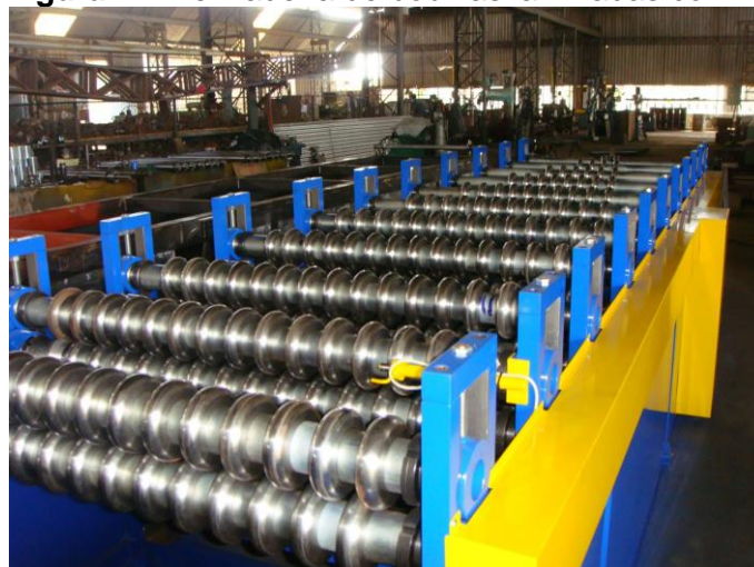
Figura 2 – Perfiladeira de bobinas laminadas com matrizes rotativas.
