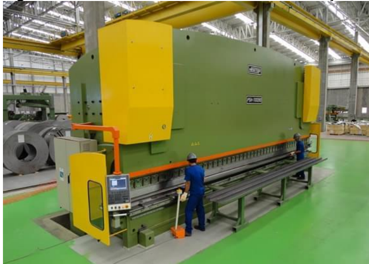
Figura 1 – Prensa hidráulica utilizada na conformação de perfis dobrados.
