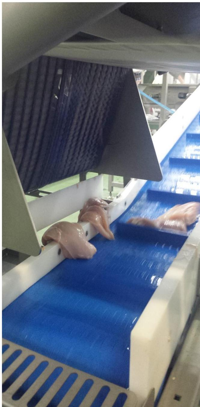
Figura 4. Esteira que interliga o corte final do peito até a seção de Raios-X.
