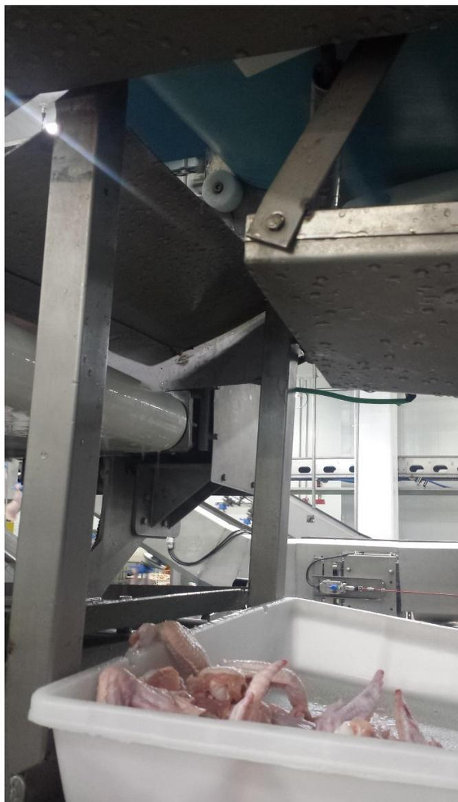
**Figura 7. Cuba para depósito de asas.**
