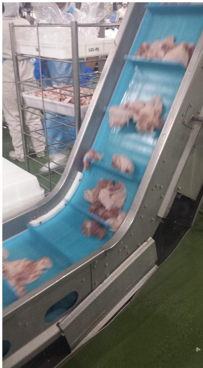
**Figura 8. Esteira de acesso para as máquinas classificadoras.**
