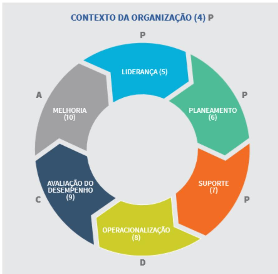
Figura 01 – Representação da Estrutura da Norma no Ciclo PDCA
