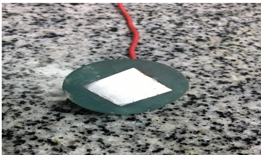
Figura 22. Corpo de prova embutido. Fonte: O Autor, 2017.
