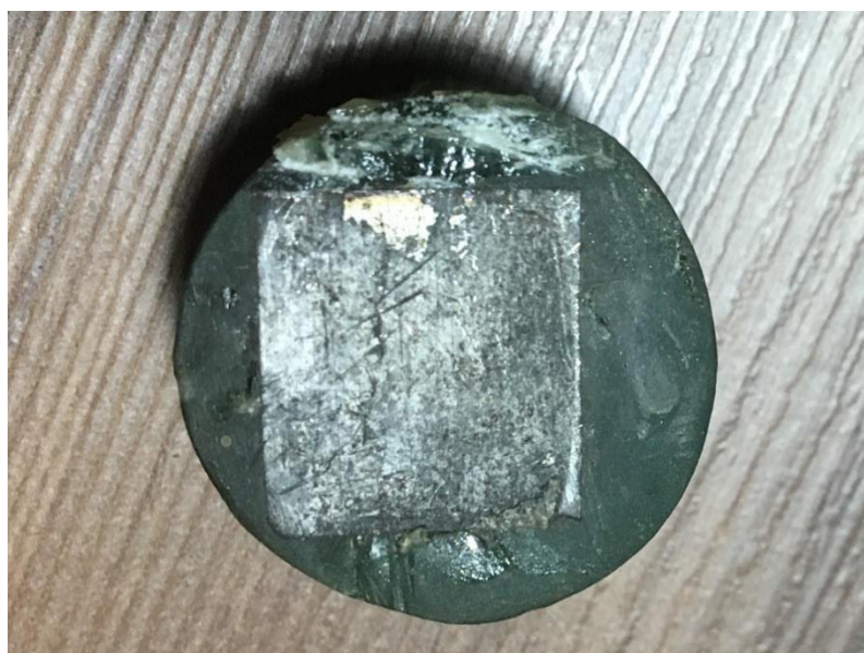
Figura 28. Corpo de prova 1 corroído Fonte: O Autor, 2017.
