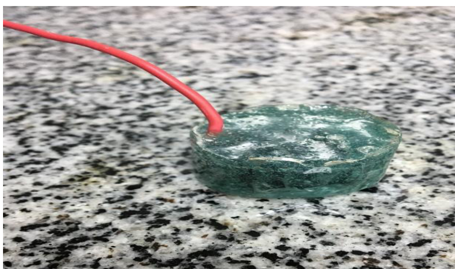
Figura 23. Corpo de prova embutido. Fonte: O Autor, 2017.
