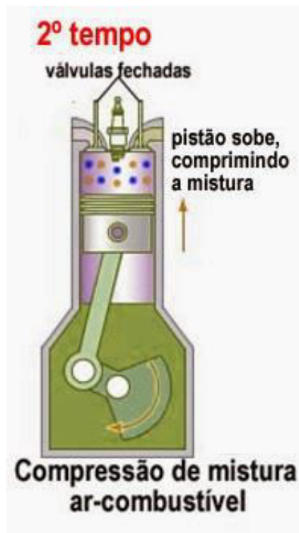
Figura 13. Segundo tempo do motor Fonte: Blog Manutenção Aeronáutica, 2015.
