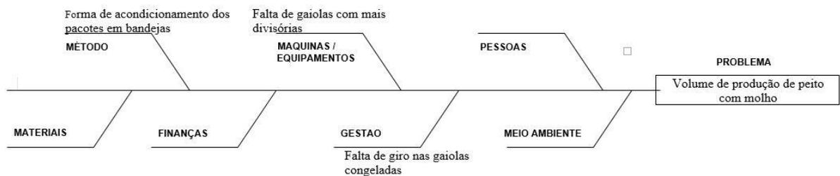
Figura 21 - Diagrama de causa e efeito volume de produção nos túneis estáticos
