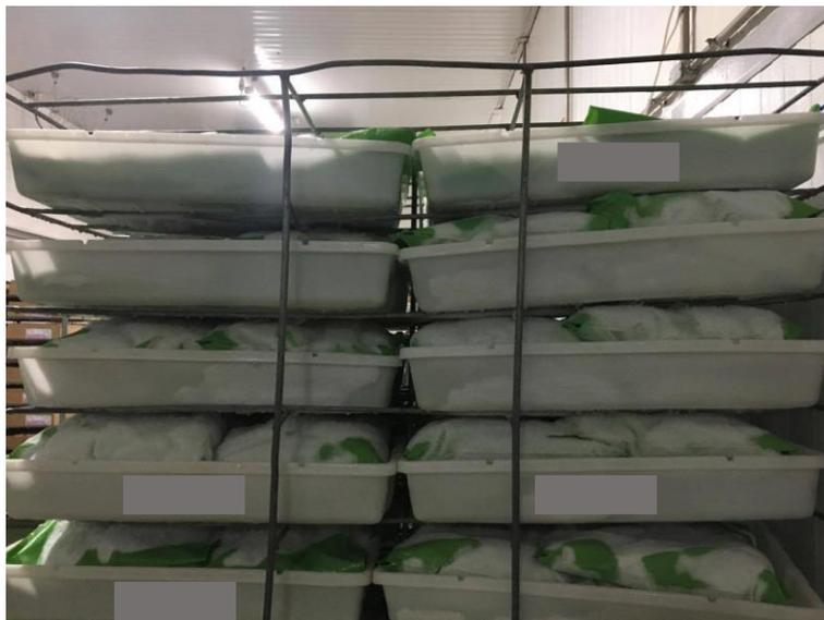
Figura 20 - Gaiola com bandejas para entrar no túnel estático
