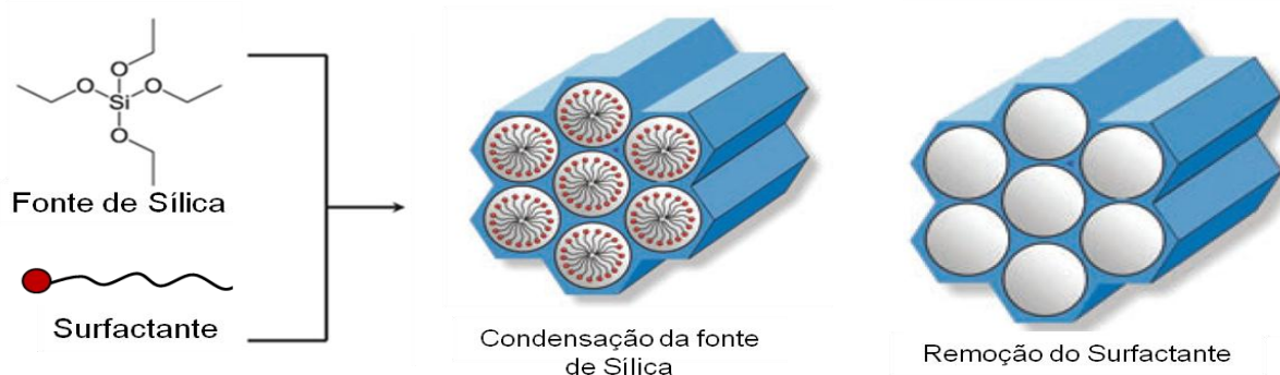
Figura 3 – Representação esquemática da síntese da SBA-15 utilizando a técnica de template , originando mesoporos cilíndricos de arranjo hexagonal.
