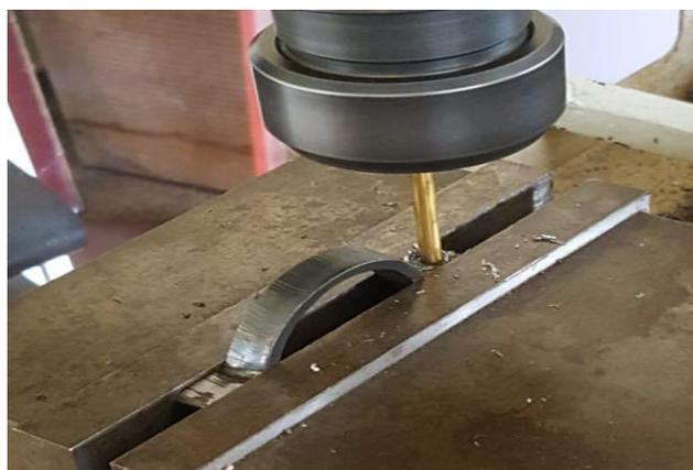
FIGURA 16. Processo de abertura de furos de 5 mm na peça abraçadeira.
