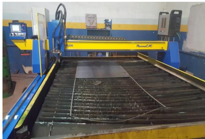
FIGURA 13. Sistema de corte e plasma CNC usado na fabricação de peças.
