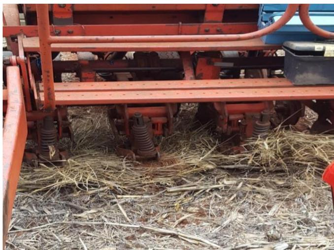
FIGURA 1. Embuchamento no disco de corte de uma semeadora-adubadora.
