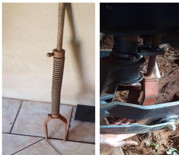
FIGURA 17. Garfo retirado da semeadora modelo PSE 8.
