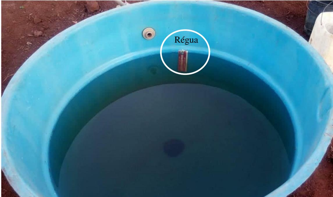
FIGURA 8. Caixa d'água com uma régua, para as medições da perda de água por evaporação.
