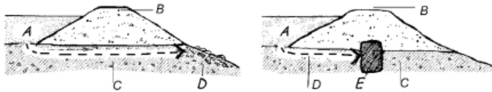
FIGURA 3. A função do núcleo (Murnyak, 1990). A: água; B: margem do tanque; C: solo; D: infiltração da água; E: núcleo de argila
