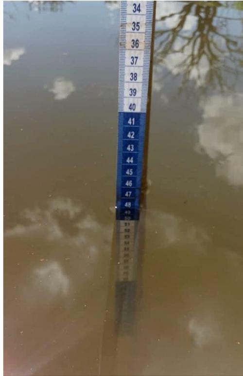
FIGURA 7. Detalhe da fita métrica utilizada para a medição da infiltração da água no solo.
