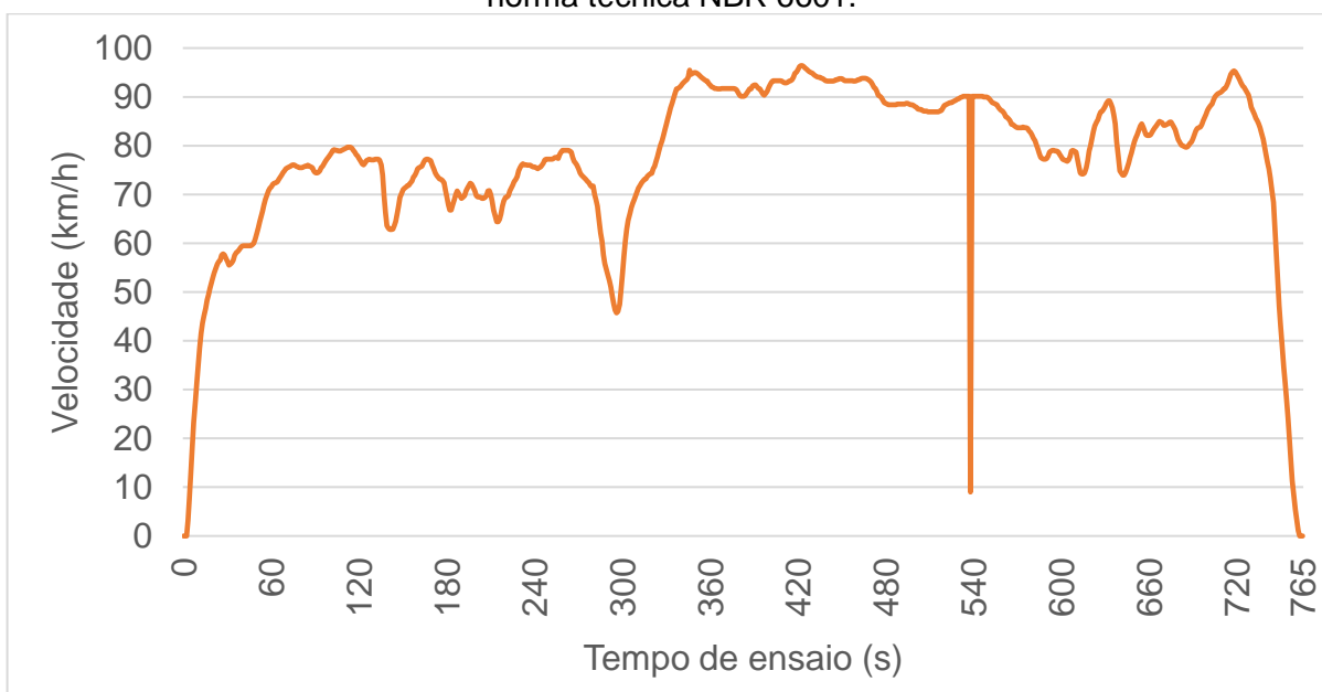
Figura 2.18. Velocidades de ensaio de consumo e emissões em ciclo rodoviário padrão da norma técnica NBR 6601.
