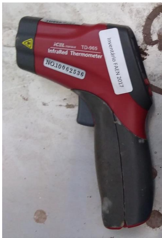
Figura 19 - Termômetro Infravermelho usado nas medições de temperatura dos tubos 25mm.
