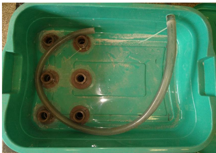
Figura 14 - Mangueira de saída de água fixada no reservatório superior.
