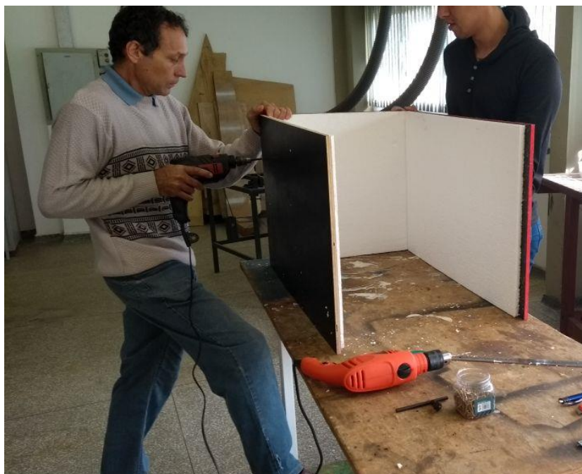
Figura 7 - Fixação das laterais do condicionador de ar experimental.
