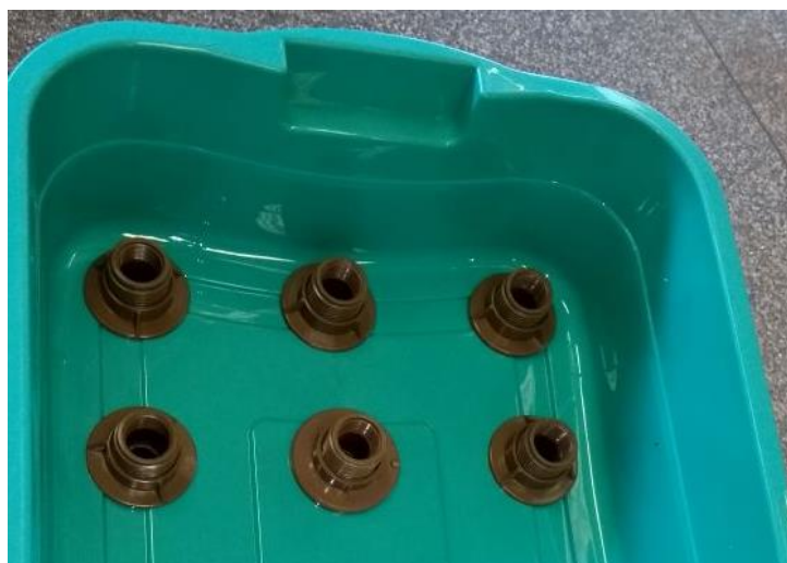
Figura 12 - Adaptadores com flange 25mm fixos no reservatório superior.
