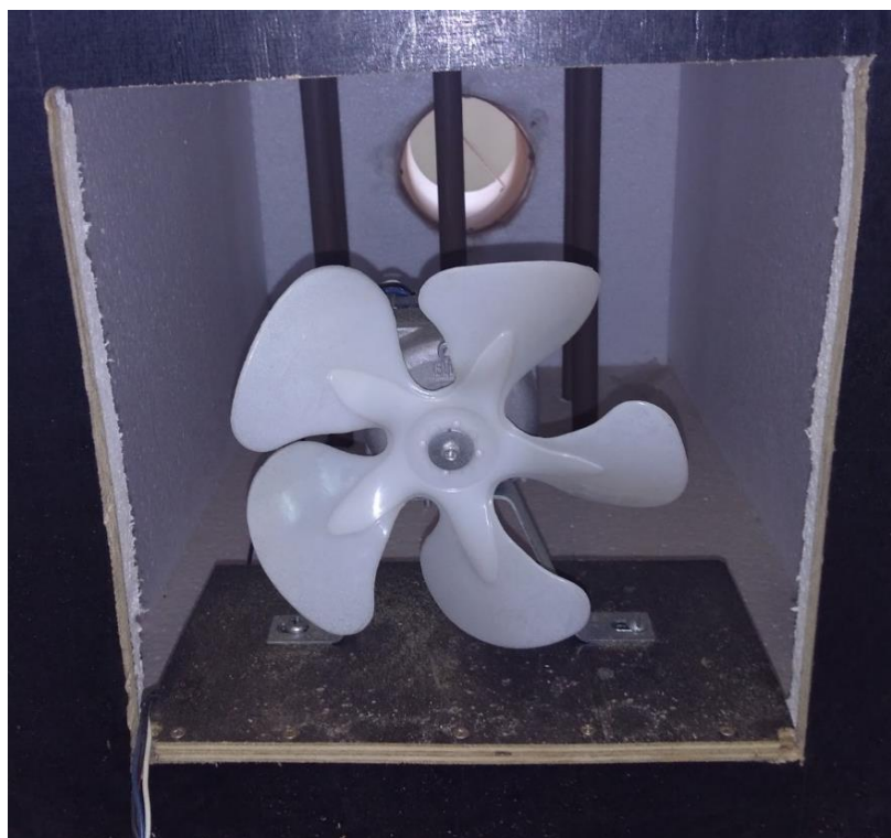
Figura 10 - Ventilador fixado no condicionador de ar.
