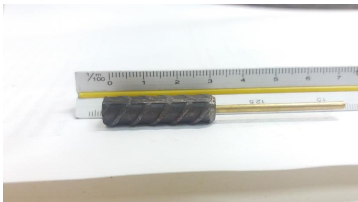
Figura 10 Foto da amostra de 3 cm utilizada para célula eletroquímica
