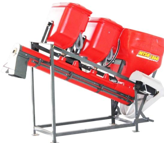
**Figura 2.** Máquina tratadora de sementes. Fonte: bandeirantes industria de máquinas.
