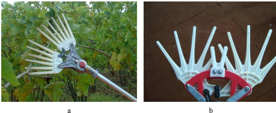
FIGURA 1. Hastes vibratórias das derriçadoras portáteis modelos Nakashi Turbo II (a) e Brudden DCM 11 (b).
