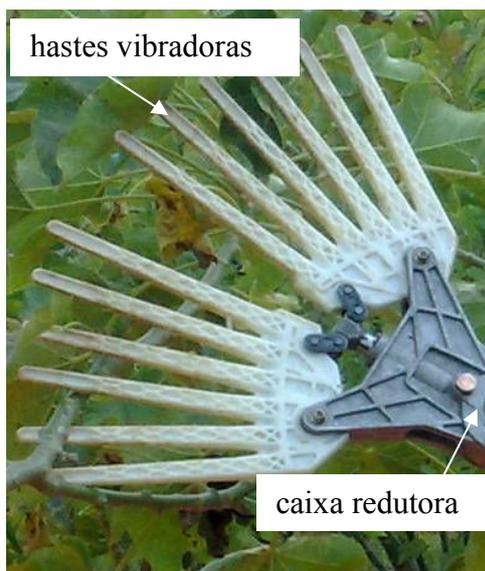
FIGURA 1. Dedos vibradores da derriçadora portátil.
